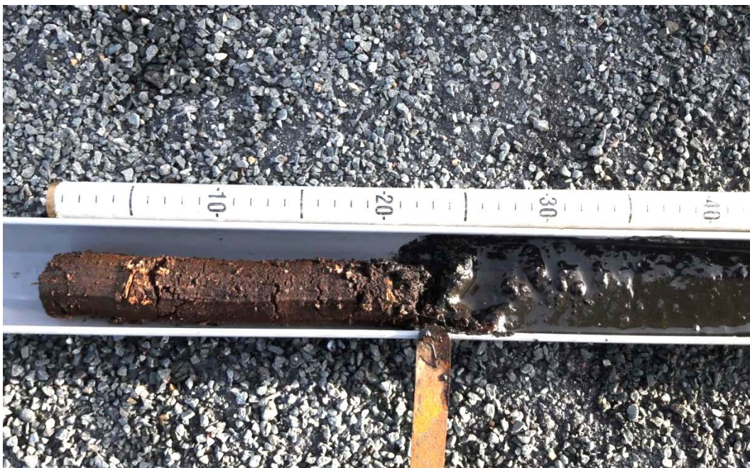
Afbeelding 5. Verificatiemeting onderzijde sedimentlaag / overgang naar vaste bodem
