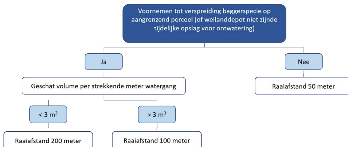
Figuur 1. Beslisboom raaiafstand handmatig meten
